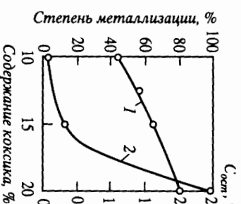
Рис. 3.62. Влияние содержания коксика на степень металлизации (1) и количество остаточного углерода (2) при обжиге в потоке газа (73% N_2 + 2% O_2 + 25% CO_2 ), температуре 1250 °С, время 10 мин, размер окатышей 14–16 мм
