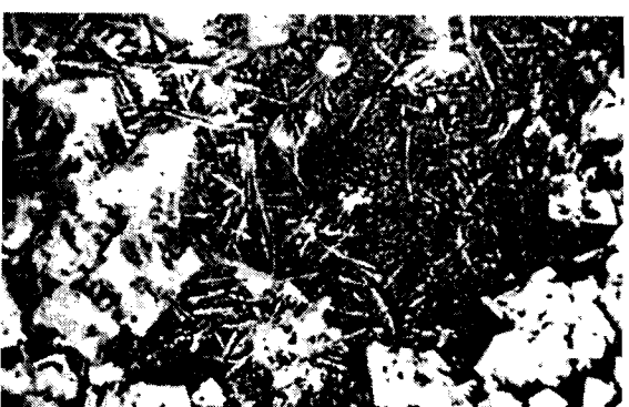
Рис. 3.37. Микрофотография участка аншлифа агломерата основностью \text{CaO}/\text{SiO}_2 = 1,4 . Белое — магнетит и вюстит; серо-белое — ферриты кальция; темно-серое — стекло; черное — силикаты кальция, \times 216
